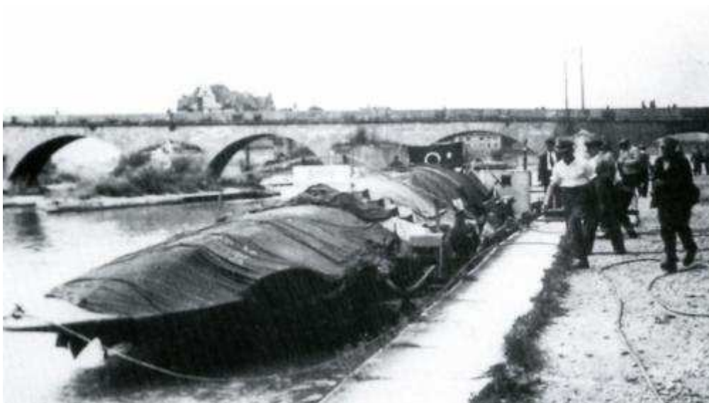
U-Boot in Regensburg: Insgesamt sechs deutsche U-Boote wurden im Sommer 1942 von der Ostsee über Elbe und Donau an das Schwarze Meer verlegt. Dabei waren knifflige Hindernisse zu passieren wie etwa die aus dem 12. Jahrhundert stammende, sehr niedrige Steinerne Brücke in Regensburg.
