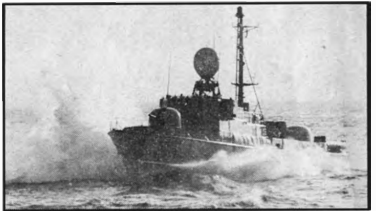
S-Boot der Klasse 143: Elektronik, Raketen, Torpedos und ein Mahagonirumpf, den akustische Minen kaltlassen
